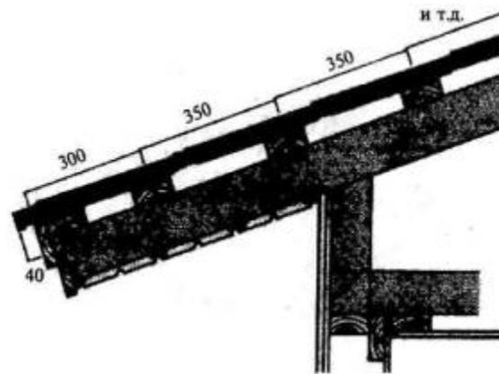
**Рисунок 5 - Устройство обрешетки**
